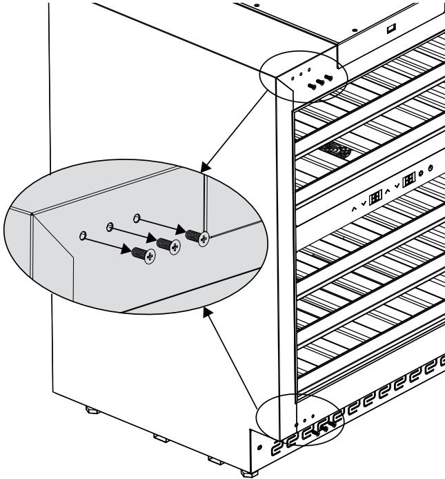
7. Coloque os distanciadores nos suportes angulares e aperte-os uns aos outros. Conforme o batente da porta, mude correspondentemente a posição.
