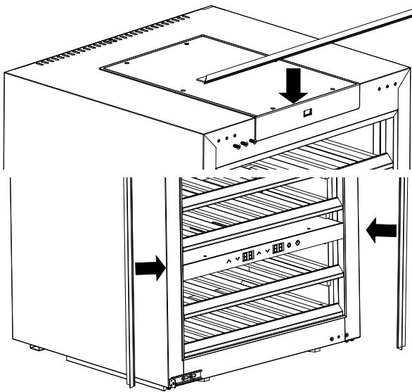
9. Insira completamente o aparelho no nicho com cuidado. Verifique as distâncias a toda a volta. Os distanciadores ajudam a posicionar o aparelho alinhado com a frente do nicho. Desaperte os parafusos (1), move os distanciadores para a parede do móvel e aperte novamente os parafusos.
