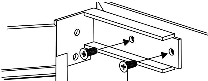
6. Установите крышку. Проверьте, надежно ли установлена дверца и хорошо ли она закрывается.
