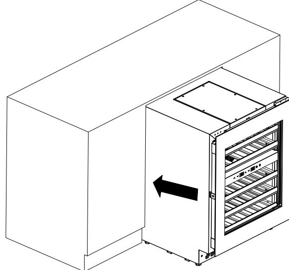
3. Schroef de stelvoetjes los met de bijgeleverde steeksleutel tot het apparaat gelijk staat met de bovenkant van het meubel. Trek het apparaat indien nodig uit de uitsparing.
