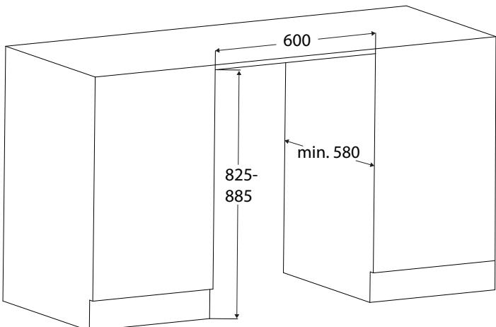
El armario de cocina deberá estar alineado horizontal y verticalmente. El cable tiene una longitud de 2 m. La toma de corriente no puede encontrarse detrás del aparato y tiene que ser fácilmente accesible. El montaje del aparato debe ser realizado únicamente por personal formado. Para ello se precisan como mínimo dos personas. Antes de proceder al montaje compruebe las dimensiones de montaje.
