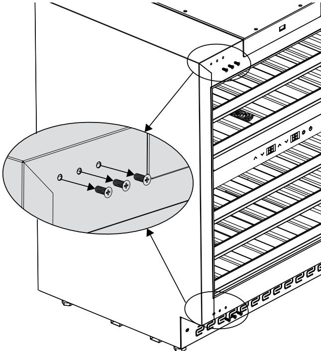
7. Introducir los distanciadores en el soporte de montaje y atornillarlos. En función del sentido de apertura de la puerta, la otra posición correspondiente.
