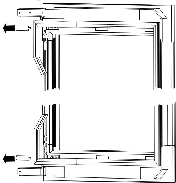
3. Schrauben aus Position 2 lösen und in Position 3 setzen. Die Schrauben an Position 1 lösen und die Tür ausrichten.
