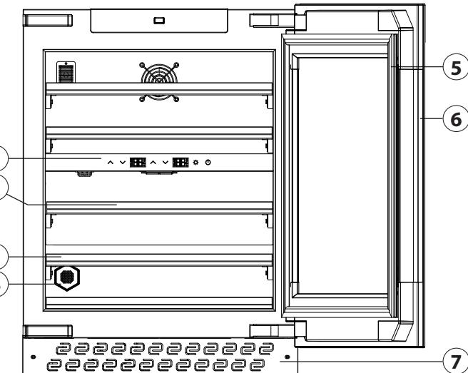
4. Снимите дверцу и поверните ее на 180°.
