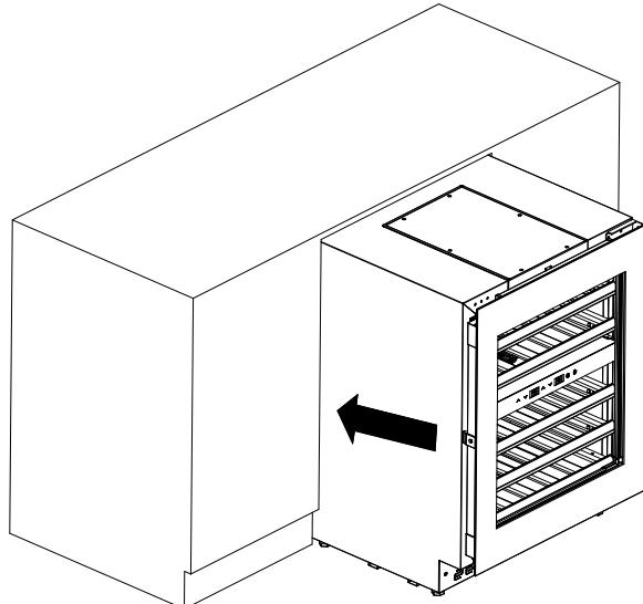
3. Desenrosque los pies regulables con la llave suministrada hasta que el aparato quede a ras con la parte superior del cuerpo del mueble. En caso necesario, saque el aparato del hueco.
