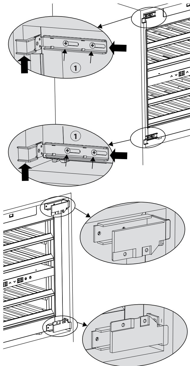
10. Fixe o aparelho ao corpo do móvel com os parafusos fornecidos através dos distanciadores e dos suportes angulares.
