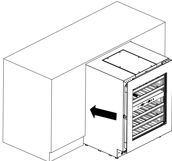
3. Desaparafusar os pés reguláveis com a chave fornecida até que o aparelho fique nivelado com a parte superior do corpo do móvel. Se necessário, puxar o aparelho para fora do encaixe.
