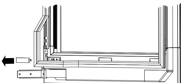
3. Lossa skruvarna från position 2 och sätt dem i position 3.
