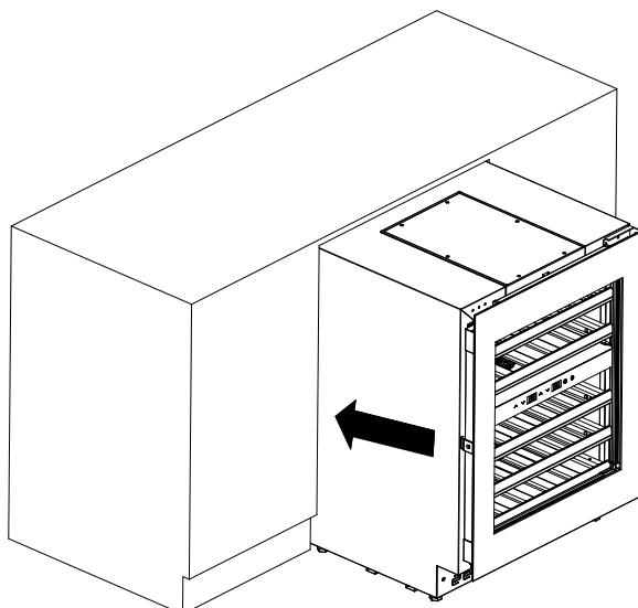
3. Dévisser les pieds réglables à l'aide de la clé plate fournie jusqu'à ce que le haut de l'appareil soit à fleur du corps du meuble. Pour ce faire, retirez l'appareil de la niche d'encastrement si nécessaire.
