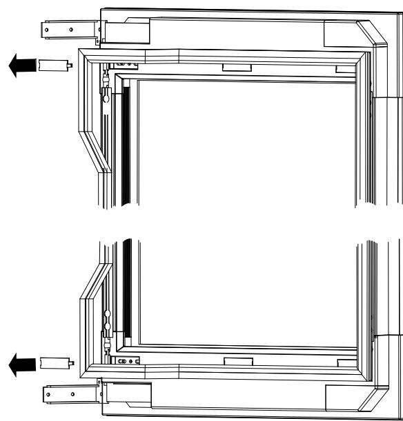
3. Desserrer les vis de la position 2 et les placer en position 3.
