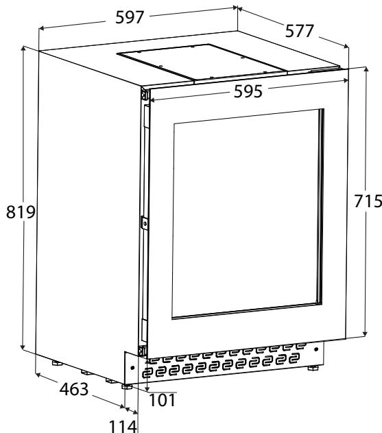
\* Die Einbauhöhe kann durch die verstellbaren Füße bis zu 879 mm erhöht werden.
