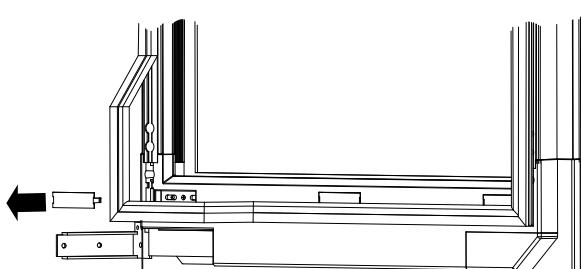
3. Soltar los tornillos de la posición 2 y colocarlos en la posición 3. Soltar los tornillos en la posición 1 y alinear la puerta.
