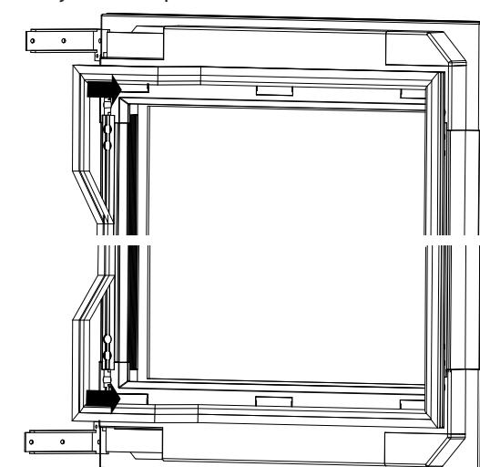
7. Para la alineación en sentido Z, cambiar la altura de los pies regulables.
