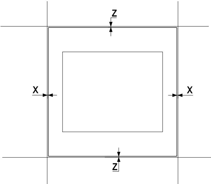
1. Retirar la junta de la puerta para la alineación en sentido X.
