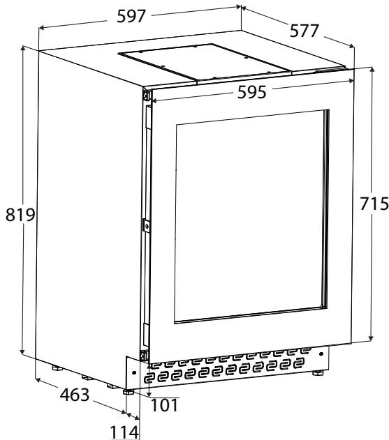
\* La hauteur d'encastrement peut être augmentée jusqu'à 879 mm grâce aux pieds réglables.
