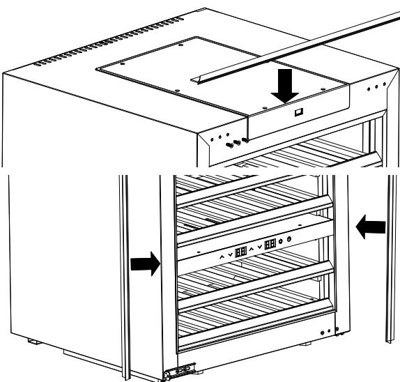
9. Introduzca completamente el aparato en el hueco. Compruebe las distancias alrededor. Las ménsulas le ayudarán a posicionar el aparato con el frente a ras. Suelte los tornillos (1), desplace los distanciadores hacia la pared del mueble y apriete de nuevo los tornillos.
