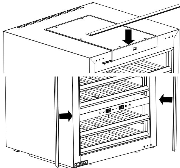
9. Skjut nu in enheten komplett i vrån. Kontrollera avstånden runt omkring enheten. Distanshållarna hjälper dig att positionera enheten i en plan linje fram till i vrån. Lossa skruvarna (1), skjut distanshållarna mot möbelväggen och skruva fast skruvorna igen.
