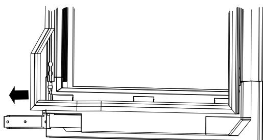
**3.** Neem de schroeven van positie 2 en plaats deze in positie 3. Draai de schroeven op positie 1 los en lijn de deur uit.
