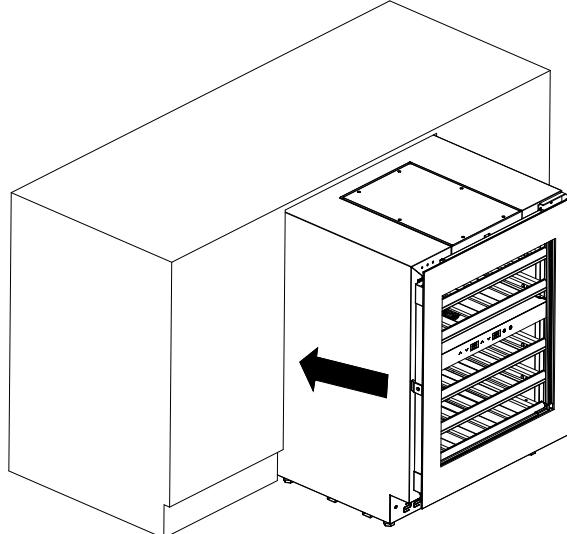
3. Stellfüße mithilfe des mitgelieferten Maulschlüssels so weit raussschrauben, bis das Gerät oben mit dem Möbelkörper bündig ist. Ziehen Sie das Gerät hierzu ggf. aus der Einbaunische.
