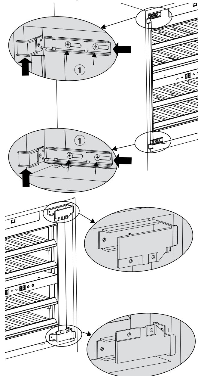
**10.** Fäst enheten med de medlevererade skruvarna genom distanshållarna och fästvinklarna på möbelkroppen.
