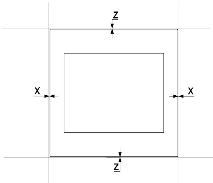
**1.** Voor uitlijning in richting X moet u de deurafdichting verwijderen.
