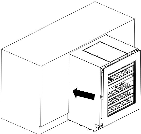
**3.** Открутите регулируемые ножки с помощью прилагаемого гаечного ключа, пока прибор не станет вровень с верхней частью корпуса мебели. При необходимости вытащите прибор из ниши.
