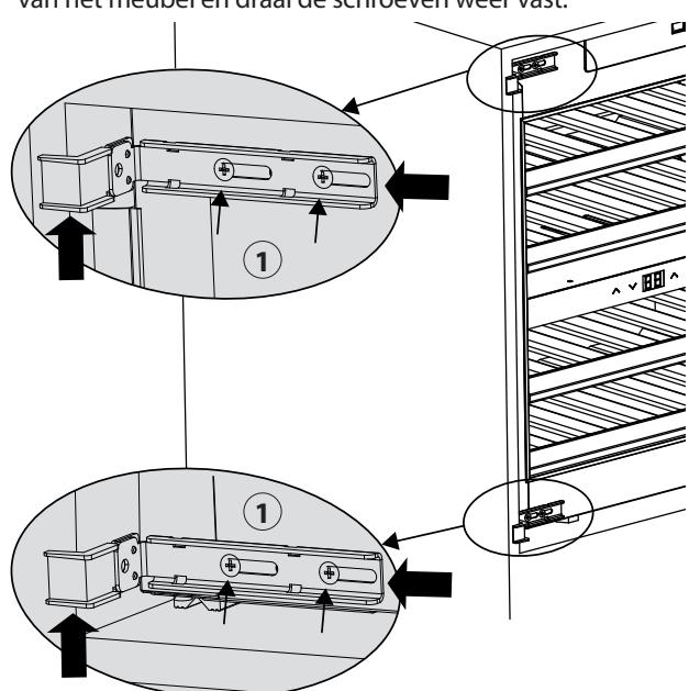
**7.** Plaats de afstandhouders op de montagebeugels en schroef alles vast. Er zijn verschillende posities, afhankelijk van het type scharnier op de deur...
