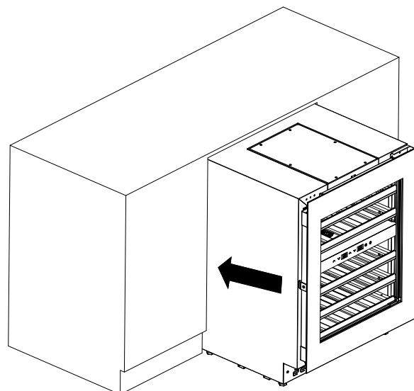
3. Svitare i piedini regolabili con la chiave in dotazione fino a quando l'apparecchio è a filo con la parte superiore del corpo del mobile. Se necessario, estrarre l'apparecchio dalla nicchia.
