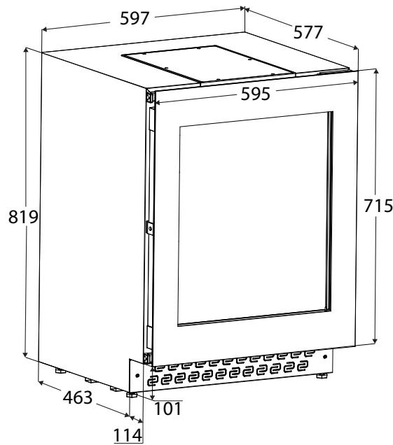
\* De installatiehoogte kan worden verhoogd tot een hoogte van 879 mm met behulp van de verstelbare poten.
