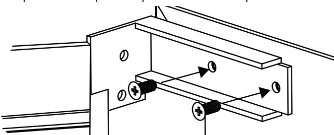
6. Coloque a cobertura. Controle se a porta está firmemente montada e se fecha corretamente.
