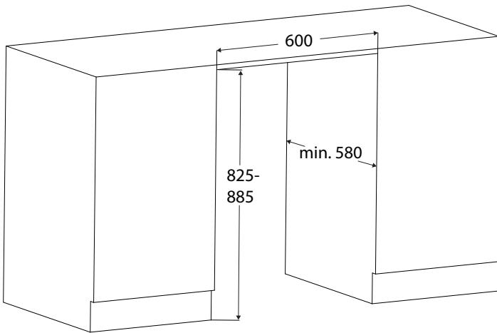
Le meuble de cuisine doit être ajusté horizontalement et verticalement.
