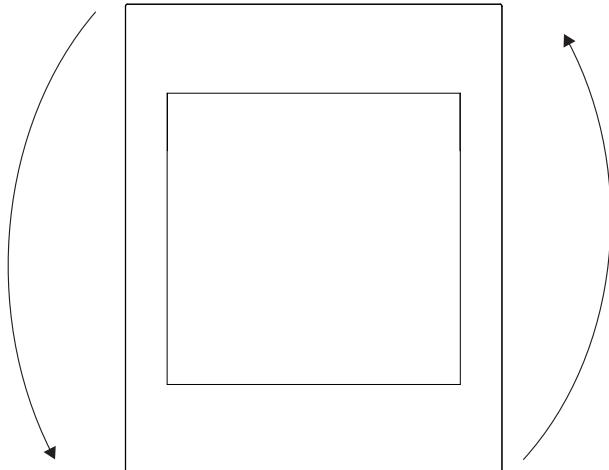
5. Colocar la puerta en el aparato. La puerta debe ser sujetada por una persona mientras la otra persona aprieta los tornillos arriba y abajo en el aparato.
