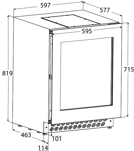
\* A altura de instalação pode ser aumentada até 879 mm por meio dos pés de ajuste.
