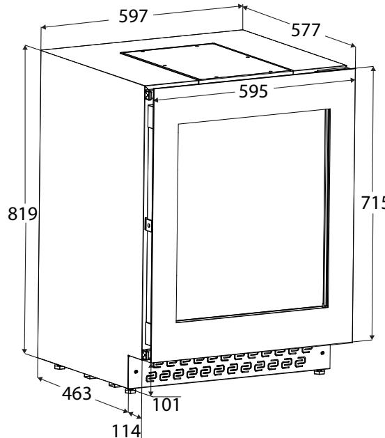
\* Передвигаемые ножки позволяют увеличивать монтажную высоту до 879 мм.
