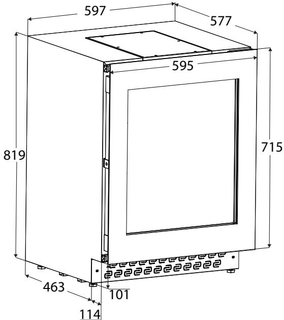
\* La altura de instalación se puede elevar hasta 819 mm mediante los pies regulables.
