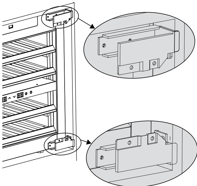
**10.** Fissare l'apparecchio con le viti in dotazione al corpo del mobile, servendosi dei distanziatori e delle staffe di fissaggio.
