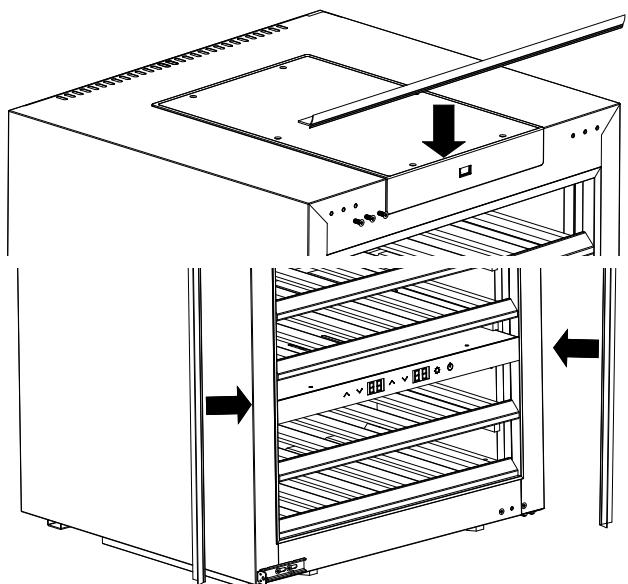
**9.** Druk het gehele in de nis. Controleer de afstand rond het toestel. De afstandhouders helpen u het toestel te positioneren in overeenstemming met de voorkant in de nis. Draai de schroeven (1) los, verplaats de afstandhouders naar de wand van het meubel en draai de schroeven weer vast.
