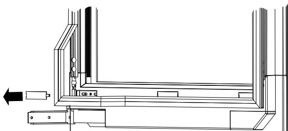
3. Desaperte os parafusos da posição 2 e coloque-os na posição 3. Desaperte os parafusos na posição 1 e alinhe a porta.
