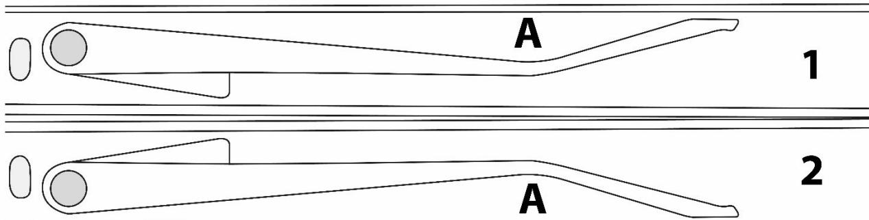
1 = unten – Lösen mit Druck an der Stelle A nach oben
