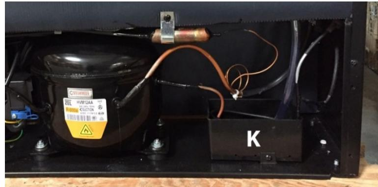
Wenn es zu größeren Temperaturschwankungen im Gerät gekommen ist oder Sie das Gerät für längere Zeit außer Betrieb nehmen wollen, dann empfehlen wir den Kondenswasser-Auffangbehälter/Auffangschale zu überprüfen. Temperaturschwankungen können zum Beispiel durch einen Stromausfall, längere/häufige Öffnung der Tür bei eingeschaltetem Gerät oder Störungen des Gerätes entstehen.
