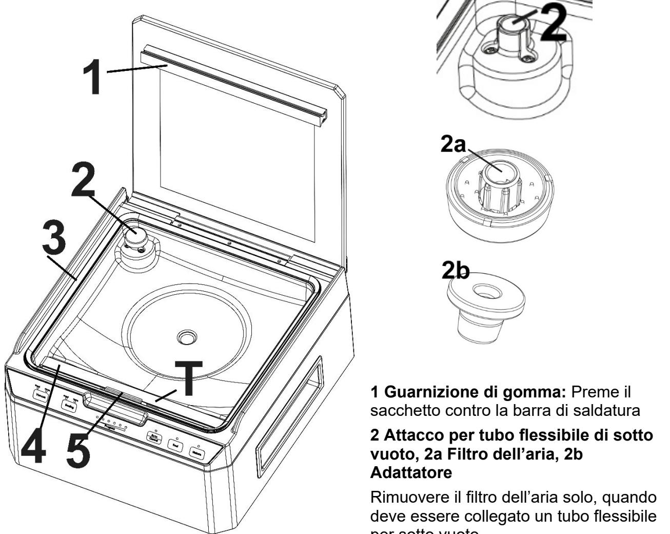
**1 Guarnizione di gomma:** Preme il sacchetto contro la barra di saldatura
