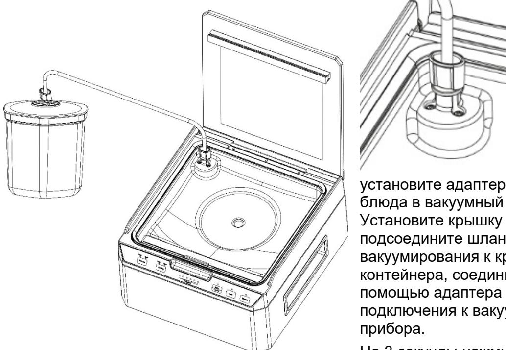
Снимите воздушный фильтр над местом подключения для вакуумного шланга и установите адаптер. Поместите блюда в вакуумный контейнер. Установите крышку контейнера и подсоедините шланг для вакуумирования к крышке контейнера, соедините шланг с помощью адаптера с местом подключения к вакуумной камере прибора.
