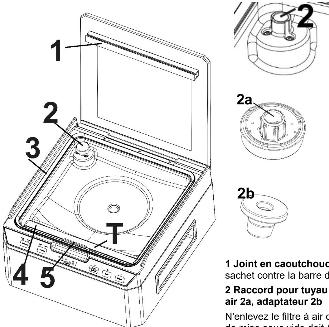
**1 Joint en caoutchouc :** Comprime le sachet contre la barre de soudure
