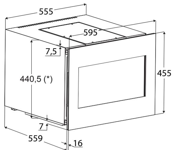
\*Die Einbauhöhe kann durch die verstellbaren Füße bis zu 455,5 mm erhöht werden.
