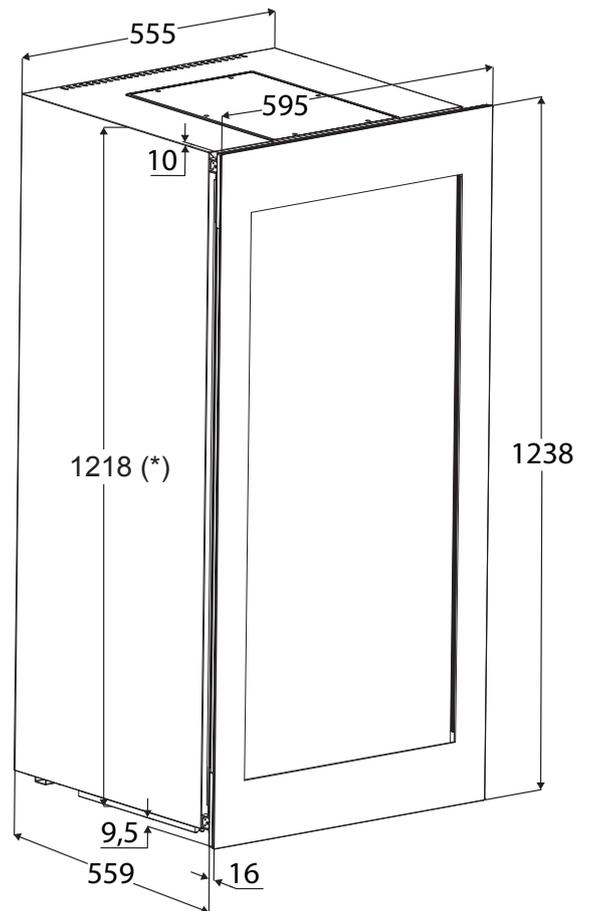
\*Die Einbauhöhe kann durch die verstellbaren FüÙe bis zu 1233 mm erhóht werden.
