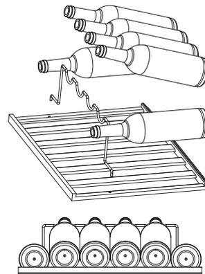
Wenn Sie die Flaschen ausstellen wollen, müssen Sie zuerst die obere Ablage herausnehmen, das Präsentiergestell in das Montageloch der Ablage einsetzen und dann die Flaschen gegen den Bügel lehnen. Da beide Seiten der Flaschen die obere Führungsschiene berühren, kann alles nur flach aufgestellt werden. Das Präsentiergestell ist im Lieferumfang enthalten.
