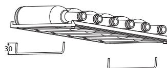
Wenn die Höhe des Lagerbodens erhöht werden soll, kann die Aufstellvorrichtung an der Unterseite des Lagerbodens angebracht werden. Der Regalboden ist im Anschluss bei geschlossener Tür sichtbar. Die Aufstellvorrichtung ist im Lieferumfang enthalten.
