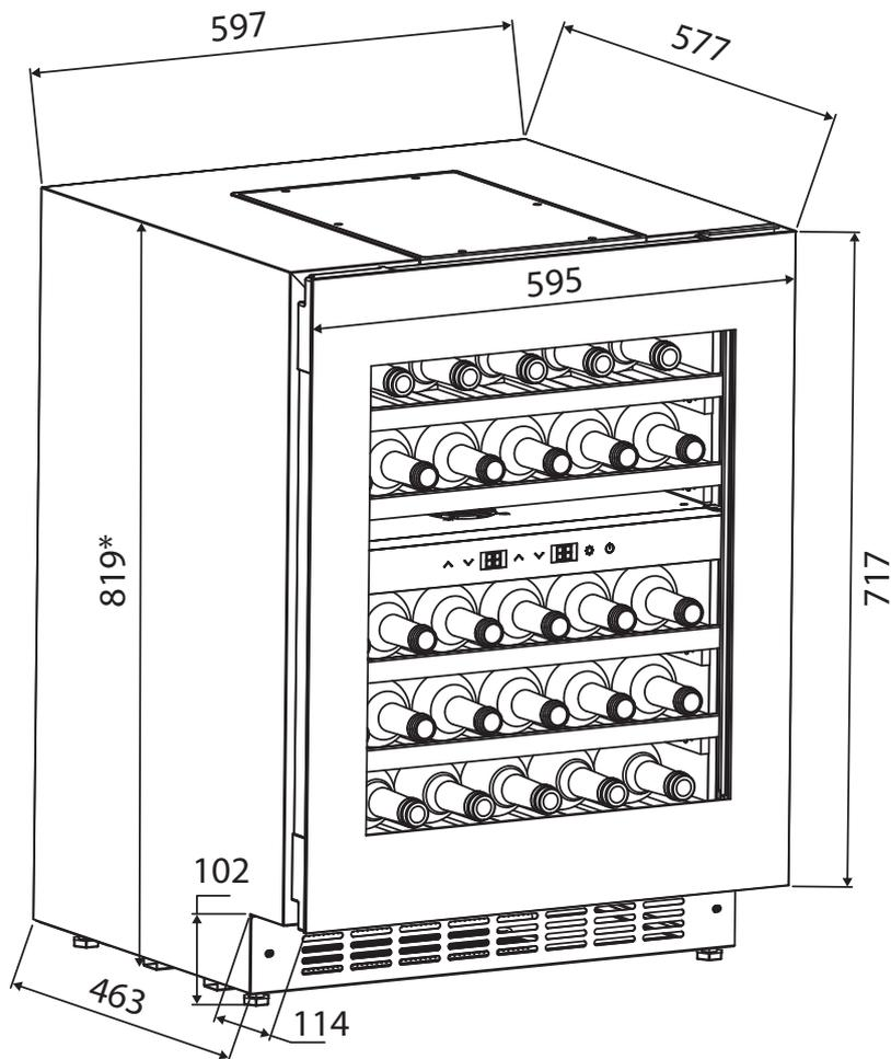
\*Die Einbauhöhe kann durch die verstellbaren FüÙe bis zu 899 mm erhóht werden.
